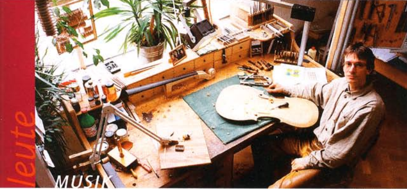
Eine „Schleske“ entsteht: Mit Spezialhobeln korrigiert der Baumeister die Form des Resonanzkörpers. Dabei geht es oft um Zehntelmillimeter.
