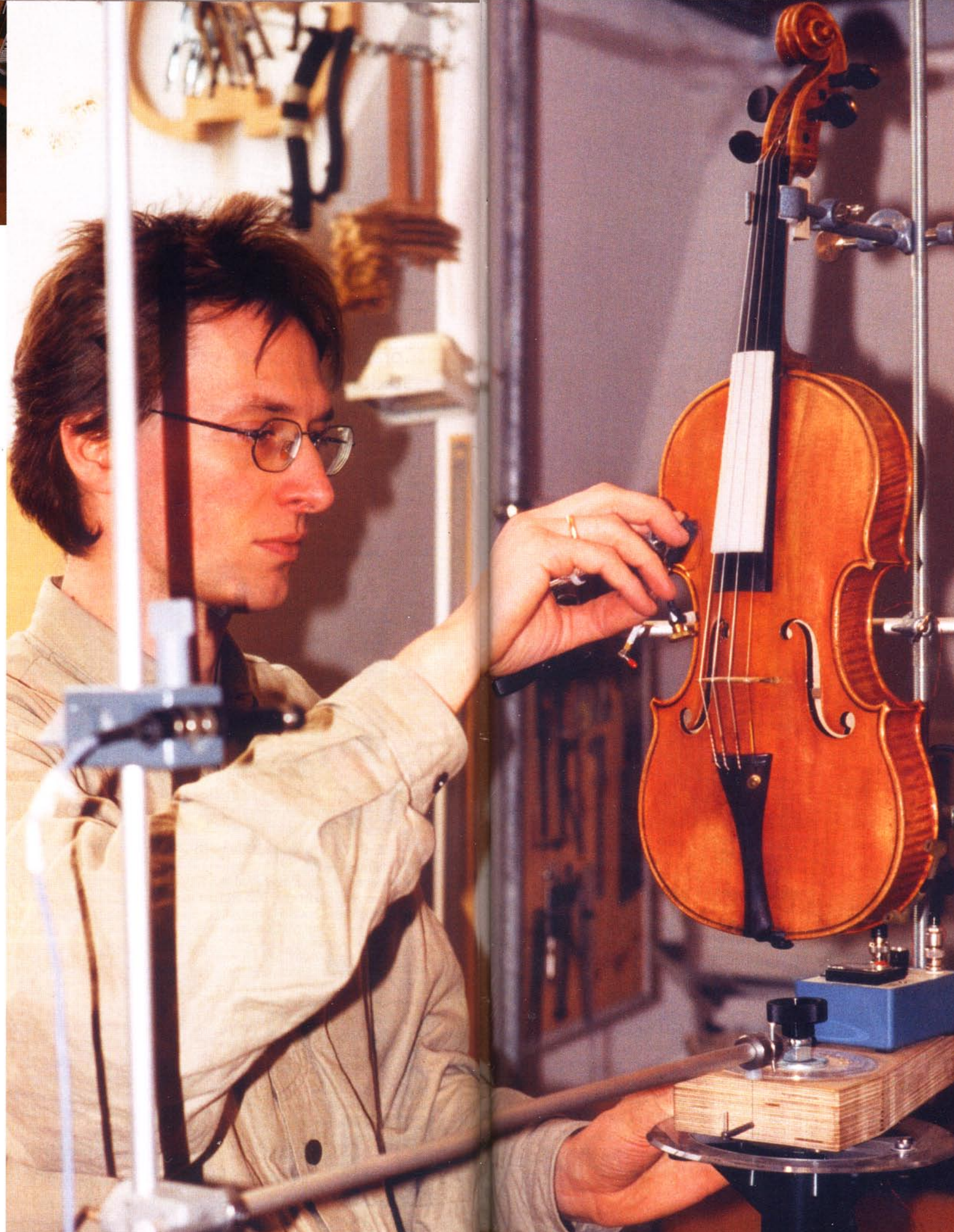
Eine „Schleske“ entsteht: Mit Spezialhobeln korrigiert der Baumeister die Form des Resonanzkörpers. Dabei geht es oft um Zehntelmillimeter.
